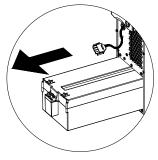
5 - Inserire nel vano apposito il nuovo battery pack facendolo scorrere fino all'aggancio con l'UPS. Ricollegare il cavo con morsetto al connettore, riportare l'interruttore in posizione "I" e richiudere il pannello frontale. Verificare che il display sia tornato in visualizzazione normale.
