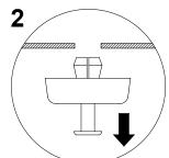
2 - Smontati tutti i piedini, si deve procedere a ruotare la maschera display. Infilare le chiavette in dotazione nelle feritoie di sgancio che si trovano ai lati della maschera display ed esercitare una leggera pressione quanto basta per sganciare la maschera dall'UPS, come evidenziato nella figura a lato.
