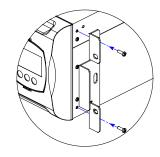
**NOTE:** L'UPS è compatibile al montaggio in armadi rack standard 600mm x 800mm o superiore (in profondità). Nell'installazione rack dato il peso dell'UPS è obbligatorio l'utilizzo delle staffe di sostegno (guida con supporto a L). Sempre per lo stesso motivo, è consigliabile installare l'UPS nella parte bassa dell'armadio rack.
