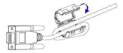
Quando si utilizza un cavetto di comunicazione RS232 o USB per ridurre le interferenze EMI, installate la ferrite fornita con l'UPS seguendo le seguenti istruzioni:
